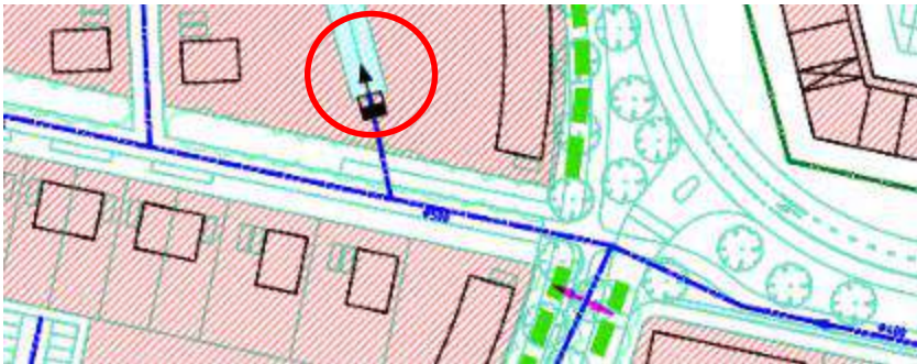
Afbeelding 12 Uitstroomriool door particulier terrein niet toegestaan
