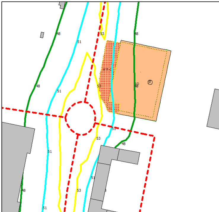
Figuur 5.6: overzicht van de berekende geluidbelasting L_{den} in dB vanwege De Noord op een waarneemhoogte h_o = +21,0 m (geluidcontouren inclusief 5 dB aftrek art. 110g Wgh) op basis van DDB
