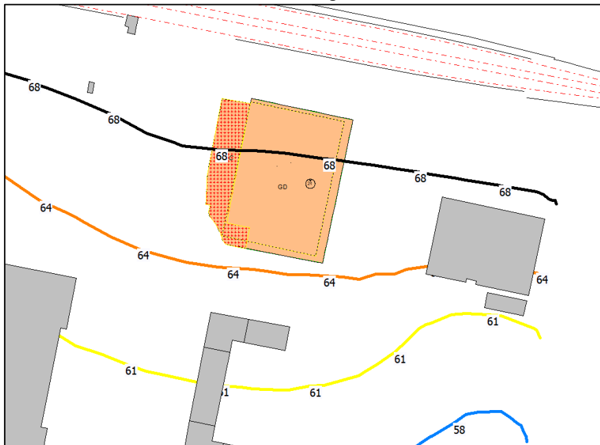
Figuur 5.5: overzicht van de berekende geluidbelasting L_{den} in dB vanwege de Hanzelijn Lelystad-Zwolle een waarnemhoogte h_o = +21,0 m
