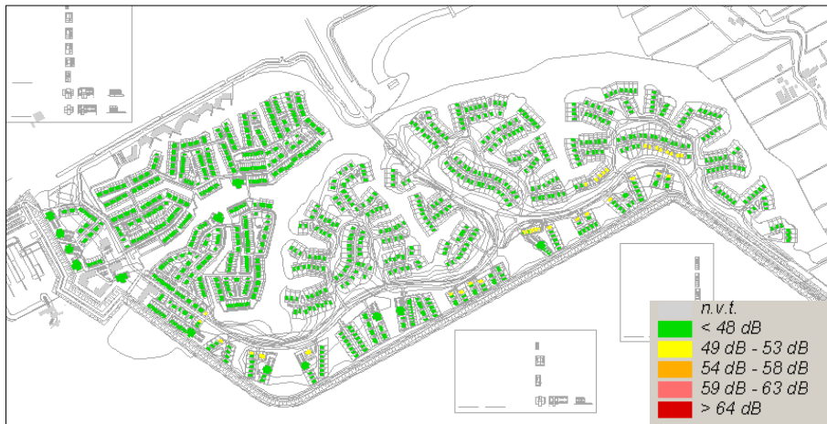
Figuur 5.1: Overschrijdingen ten gevolge van wegverkeer Reeve met geluidsreducerend asfalt (-3 dB)
