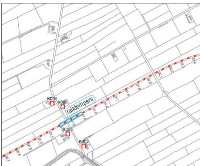
Figuur 3.1: Toegepaste raildempers ten oosten van het Randmeer (bron: 'Tracébesluit Hanzelijn, anticiperen Bypass IJssel')
