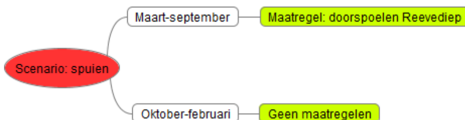
Figuur 5.13 Beslisboom scenario spuien. In paragraaf 5.5 staat per scenario beschreven welk bedieningsprotocol erbij hoort
