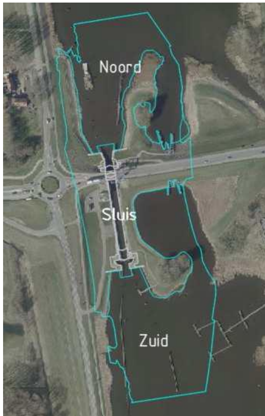
Afbeelding 5.30 Locaties af te graven grond voor de vaargeul scope van de hoeveelheid grond uit de grondbalans voor de vaargeul
