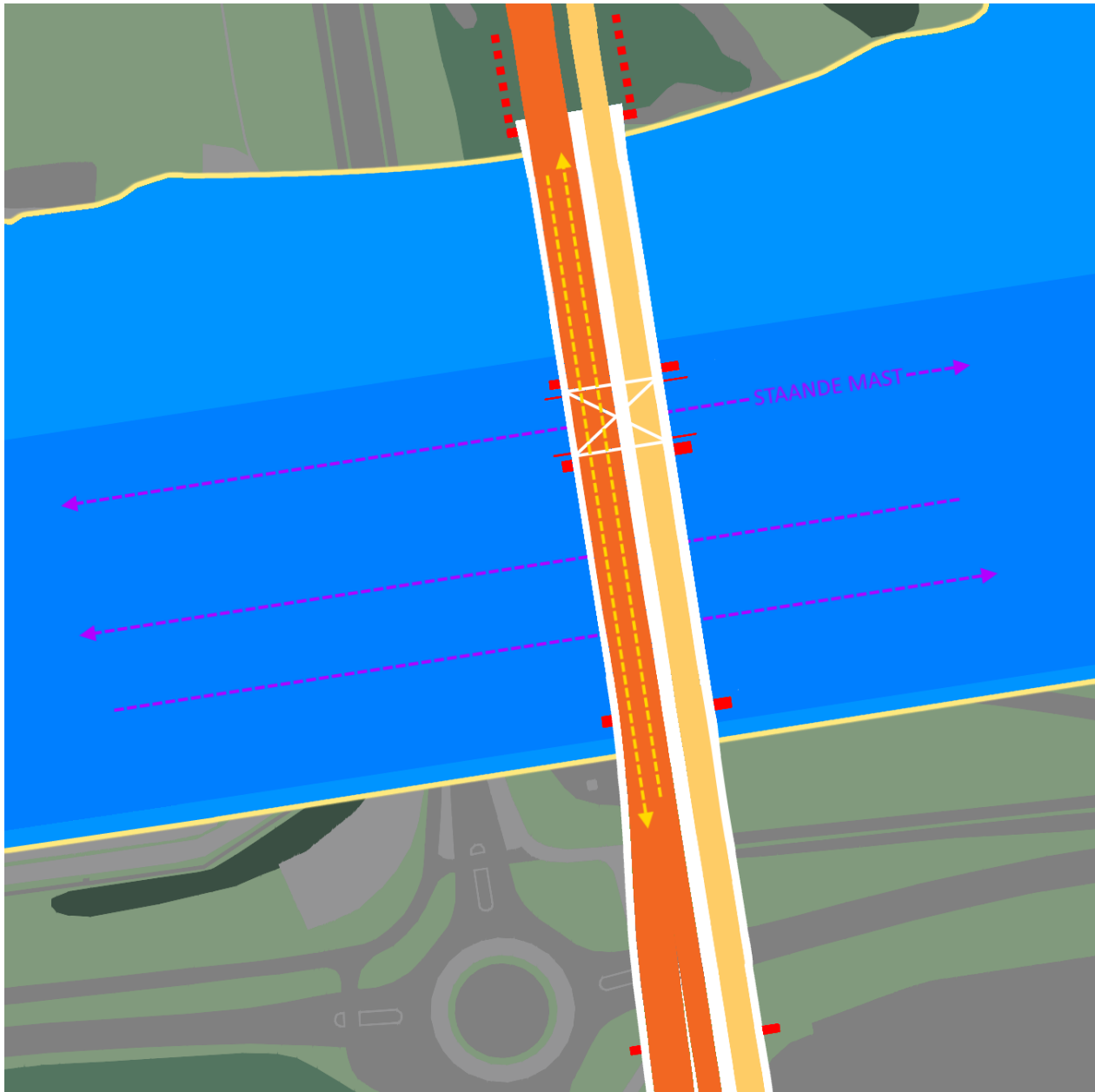
Figuur 2-19: Eindresultaat fase 5: Eindfase brug afgebouwd, aansluitingen aan beide zijden gereed (nieuwe weginfrastructuur niet weergegeven)
