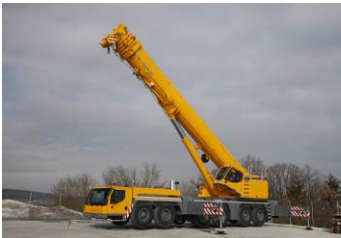
Figuur 2-12: Mobiele kraan (hefvermogen orde 400 ton)
