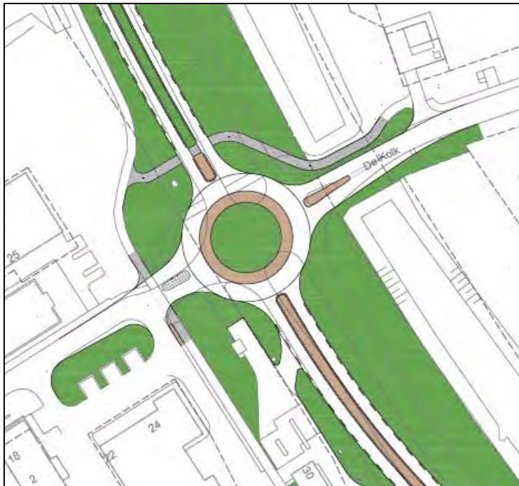
Figuur 3.1: Kleine rotonde (buitenstraal van 20 meter) op de aansluiting met De Poort
