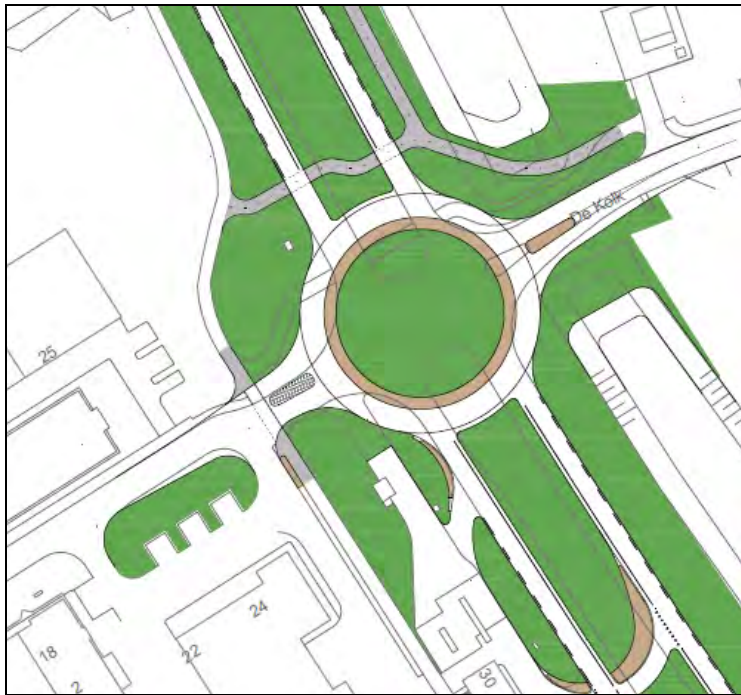
Figuur 3.2: Rotonde met een grote buitenstraal (25 meter) op de aansluiting met De Poort
