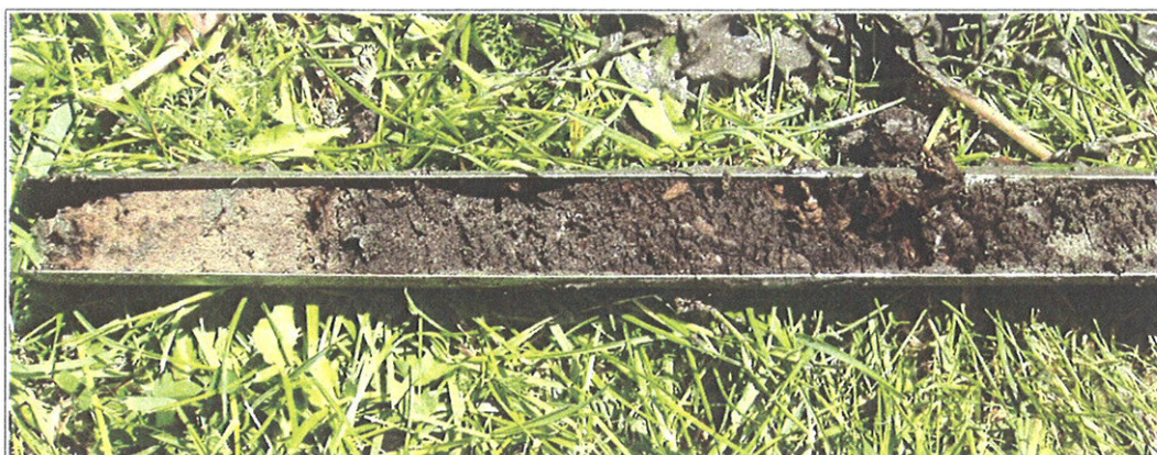
Figuur 8: Dronten, AZC: boring 8: 440 tot 470 centimeter beneden maaiveld. Links in de guts beige zand, rechts daarvan het bovenliggende veen waarvan de onderste tien centimeters (midden foto) sterk zandig zijn.
