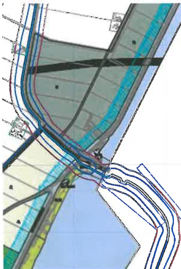
figuur B2.2 PR-contour rondom de leiding A-570-01
