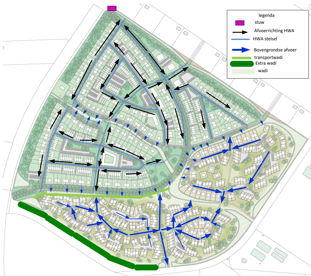
Figuur 4-3 overzichtstekening met schetsmatig de afvoer van hemelwater weergegeven. In de groengrijze vlakken zijn de wadi's weergegeven. In donkerblauwe pijlen is de bovengrondse afvoerrichting weergegeven, in lichtblauwe lijnen het regenwaterstelsel (met in zwart de stromingsrichting) en in lichtgroen is een transportwadi weergegeven. Een extra wadi is ingetekend in donkergroen, welke nog wordt toegevoegd aan het stedenbouwkundig plan
