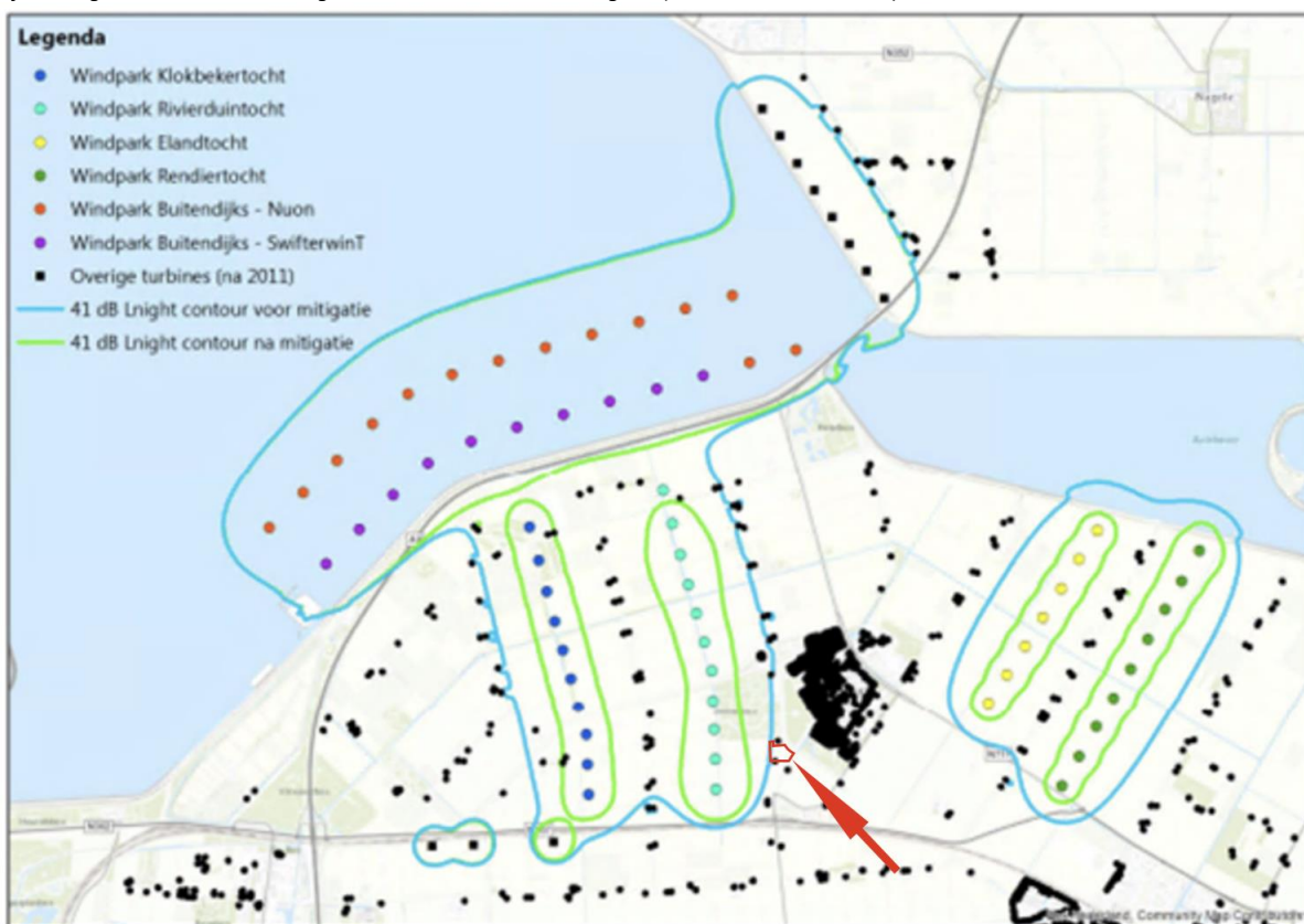
Afbeelding 5.5 41 dB Lnigt geluidscontour voor en na mitigatie (Bron: Witteveen en Bos)
