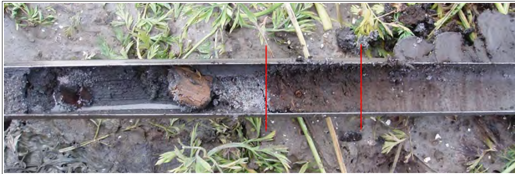
Figuur 8: Swifterbant, Visvijverweg 14: monster boring 4 van circa 470 tot 490 centimeter diepte (-9,0 tot -9,2 meter NAP). Er zijn drie lagen zichtbaar: links pleistoceen zand met houtresten, midden kleiig (basis)veen, rechts gelaagde matig slappe licht humeuze zeer zware klei.
